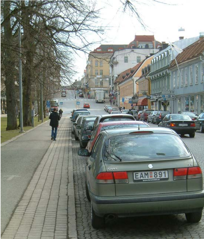
Cyklisterna på cykelbanan längs Hoglands Park skyddas idag mot plötsligt öppnade bildörrar av en remsa mellan cykelbanan och parkeringsfältet.
