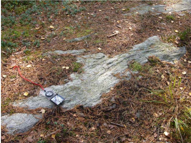
Bild 3. Km 7/000-km 7/600 Gnejs med granodioritisk sammansättning, grå till rödgrå, fint medelkornig, ådrad.
