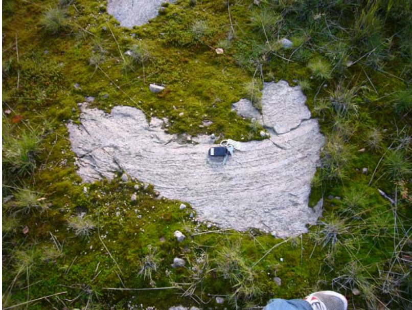
Bild 5. Km 15/000-km 15/450 Gnejs med granitisk sammansättning, röd till gråröd, fint medelkornig, ådrad.
