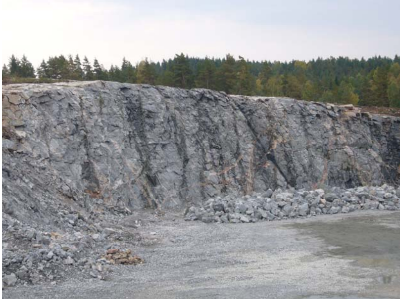
Bild 2. Holmens bergtäkt med granodioritisk gnejs, fint medelkornig, röd till gråröd, ådrad.
