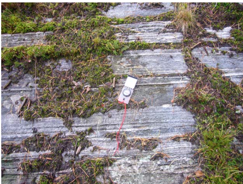
Bild 4. Km 11/950-km 12/300 Gnejs med granodioritisk sammansättning, grå till rödgrå, fint medelkornig, ådrad.
