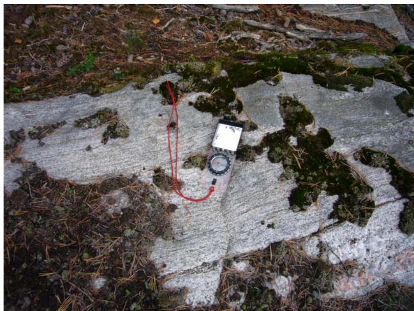
Bild 1. Km 2/500-km 3/000 Gnejs med granitisk sammansättning, fint medelkornig, röd till rödgrå, ådrad.
