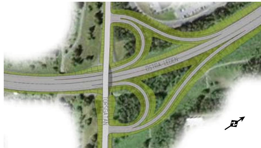
Exempel på möjlig utformning av trafikplats vid korsningen Östra Leden och Torsgatan. Här med Torsgatan passerande över Östra leden.
