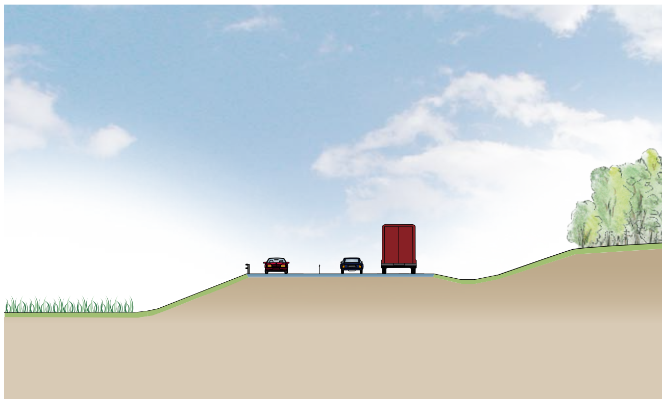
Skärning med slänter som omger vägområdet. Här ett exempel där släntfot och slänkrön avrundats för att skapa en naturlig övergång till omgivande mark.
