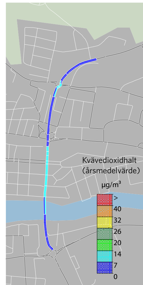
Beräkningsresultat för kvävedioxid och partiklar PM 10 i Nollalternativet, Alternativ Effektivare trafik/Nollplus och Alternativ Befintligt läge. Röd färg innebär att normen är överskriden.
