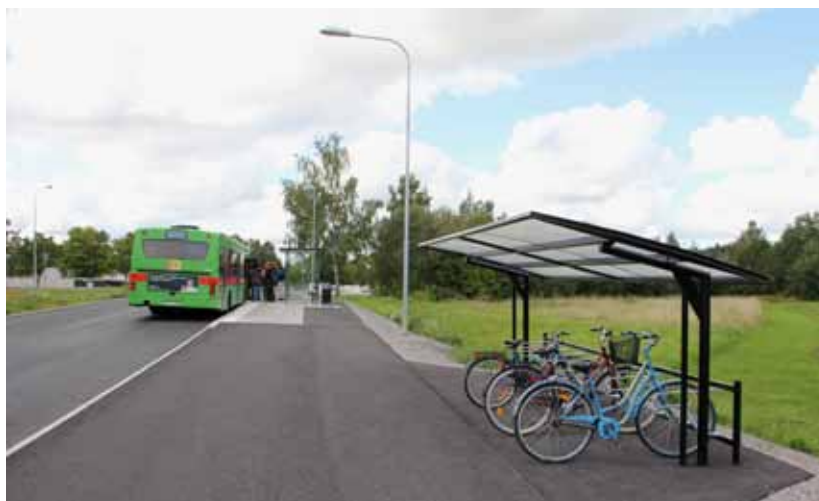
Figur 2.8. Exempel på cykelparkeringar med tak och belysning
