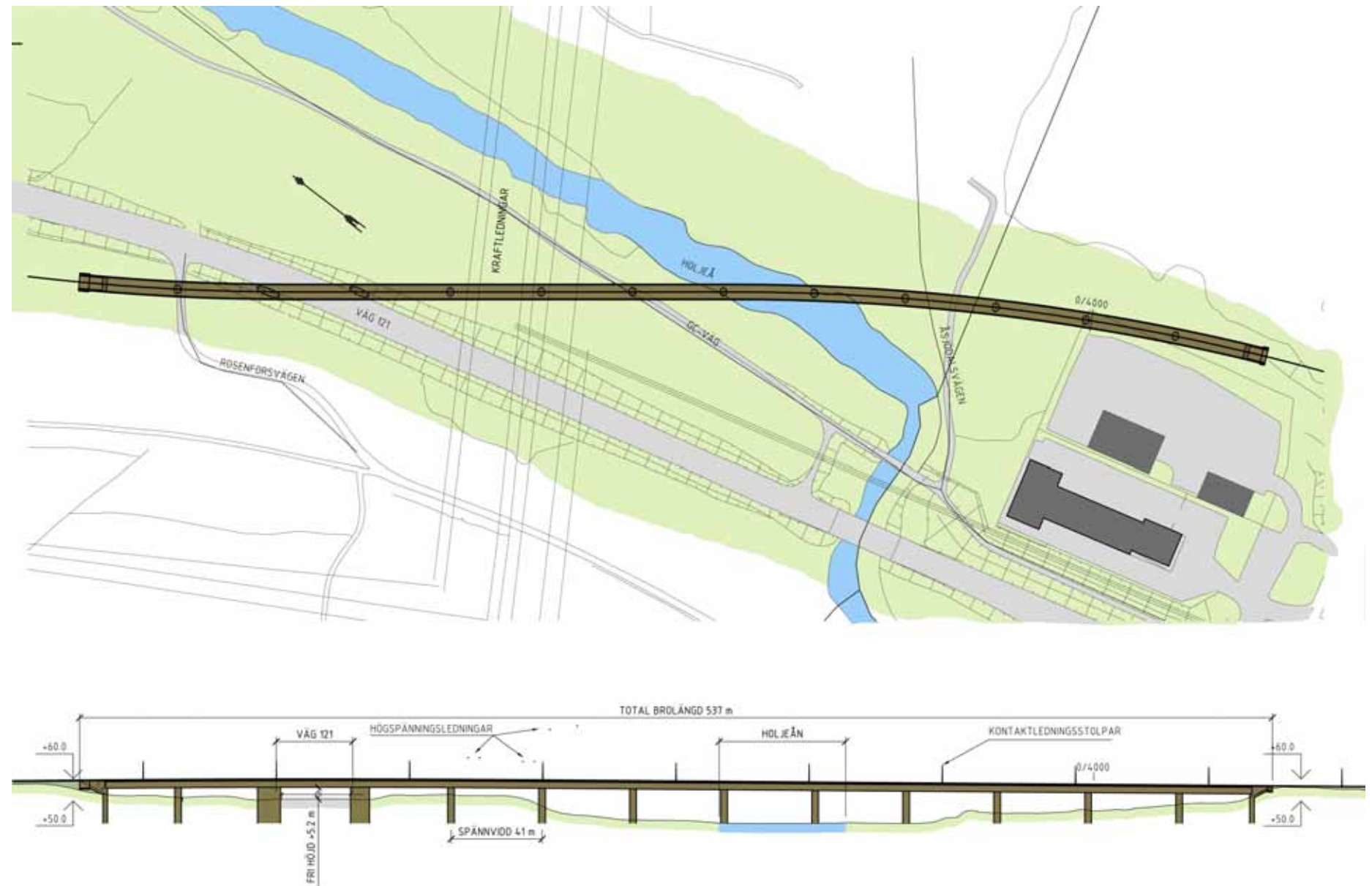
Figur 6.15 Broskiss för exempelbro ett. Plan överst, sektion underst.
