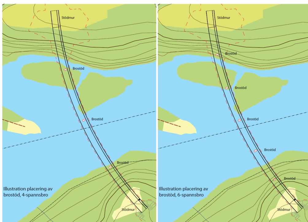
Figur 2. Illustrationer med placering av brostödens pelare. 6-spanssalternativet till höger och 4-spanssalternativet till vänster.
