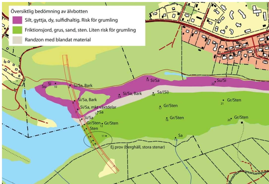
Figur 10. Sedimentkartläggning nedströms broläget. Provtagning har utförts vid 25 provpunkter fördelade längs en ca 900 m lång sträcka. Vid provpunkterna vid bronns södra landfäste har något sedimentprov inte kunnat tas upp på grund av att botten här består av berg och stora stenar.
