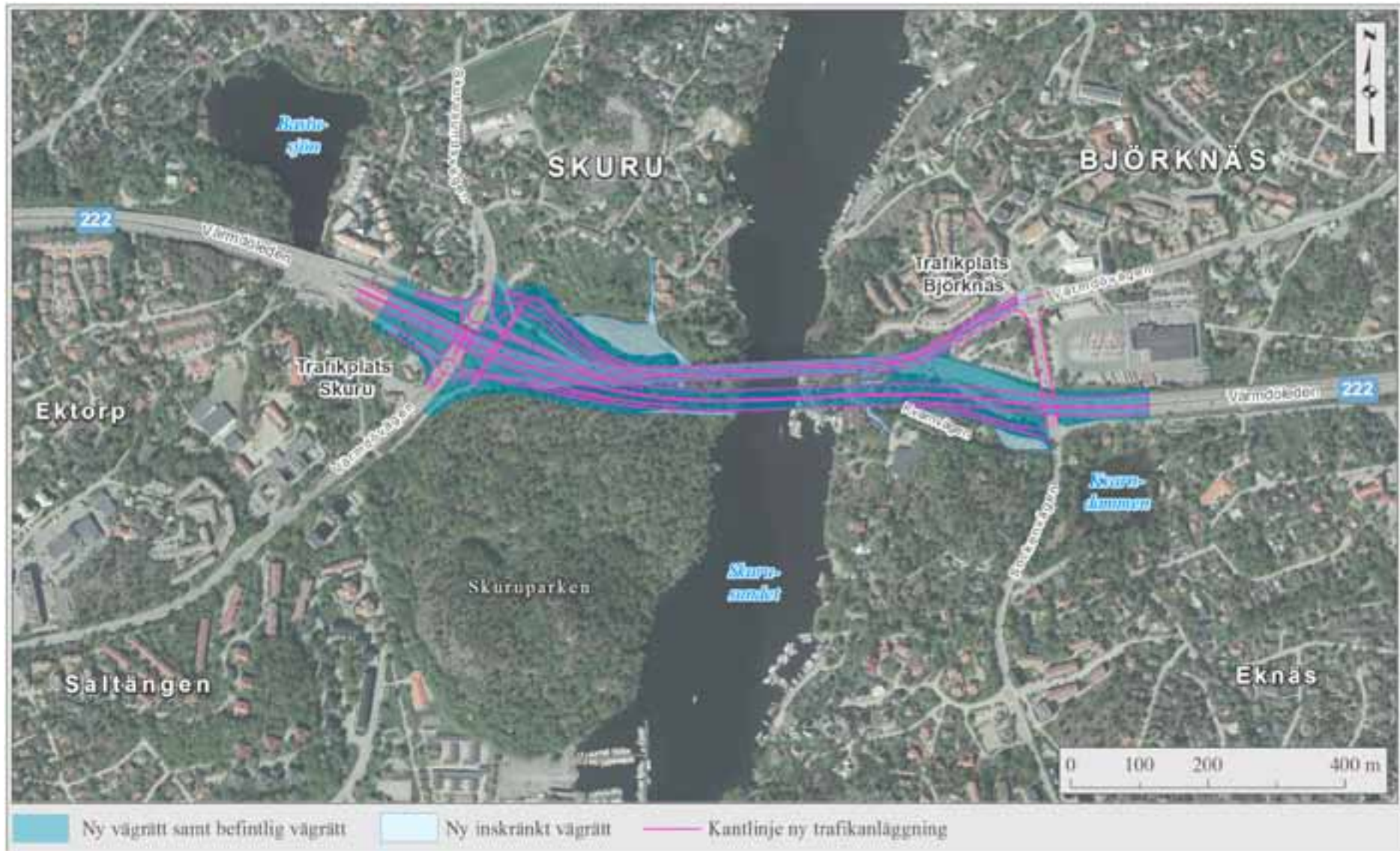
Figur 8 Översiktlig beskrivning av den nya trafikanläggningen.
