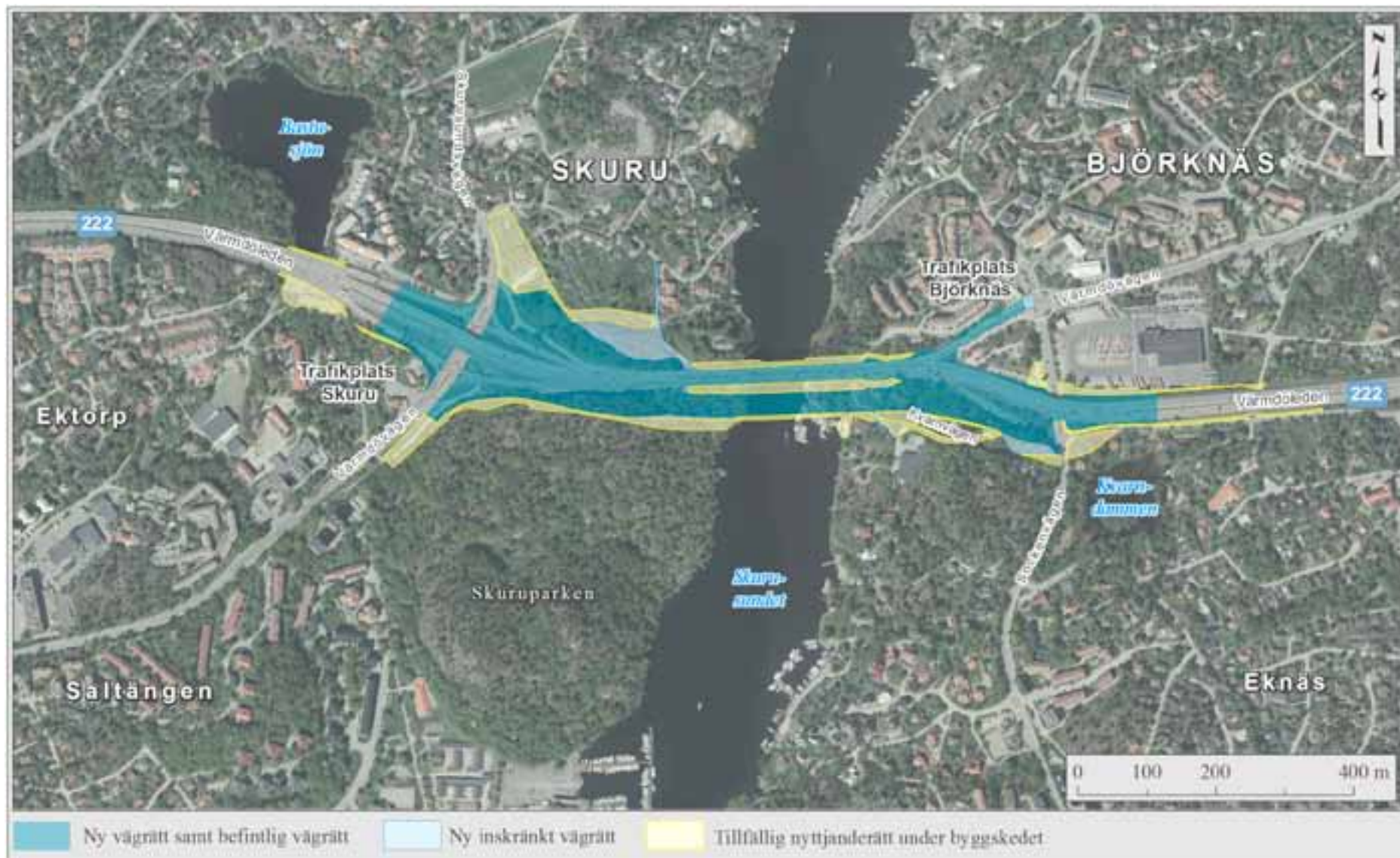
Figur 5 Översikt av de ytor som på ett eller annat vis kommer nyttjas under byggskedet. Observera att Värmdöledens befintliga vägfunktion kommer att kunna behållas under hela byggtiden.
