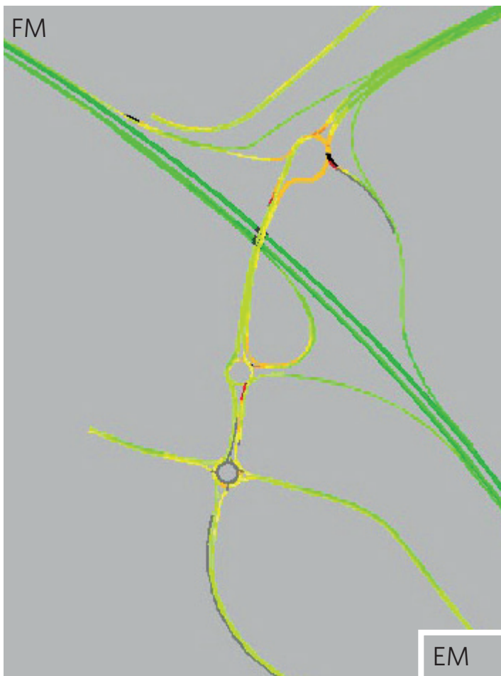
Figur 6, Trafikens hastighet på förmiddag (FM) respektive eftermiddag (EM) efter ombyggnad med bl.a. direktramper i nordost och cirkulationsplats i den södra rampanslutningen, samt med trafikmängderna år 2035 och 2+2 körfält på Rotebroleden (ögonblicksbild under högtrafiktimmarna). Mörkgrönt=80-110 km/h, svart=0-5 km/h. Resultat från datorsimulering med VISSIM.
