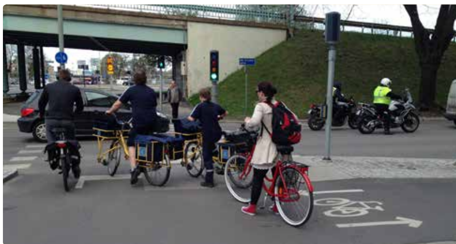
Utformningen av cykelöverfarten gör att väntande cyklister blockerar för passerande.
