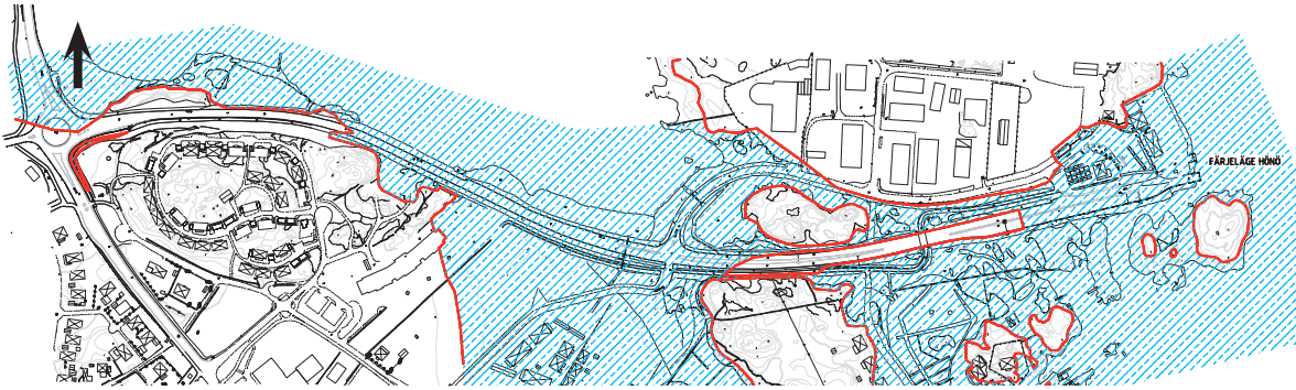
Figur 4.4a-b. Väg 155 med färjeläget Höno (figur a ovan) respektive Björkö (figur b till vänster) vid en havsnivåhöjning till +2,5 m. Blå ytor står då under vatten.
