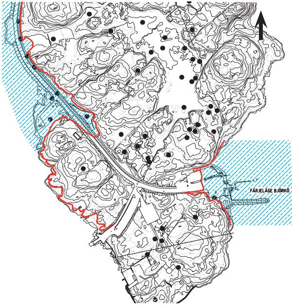
Figur 4.4a-b. Väg 155 med färjeläget Höno (figur a ovan) respektive Björkö (figur b till vänster) vid en havsnivåhöjning till +2,5 m. Blå ytor står då under vatten.
