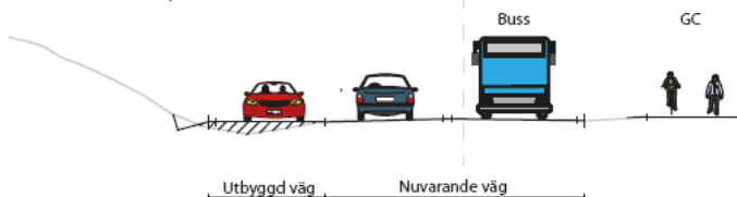
Figur 5. Möjlig utformning för respektive alternativ vid några valda sektioner. Sektionsindelning enligt Figur 4 (1).
