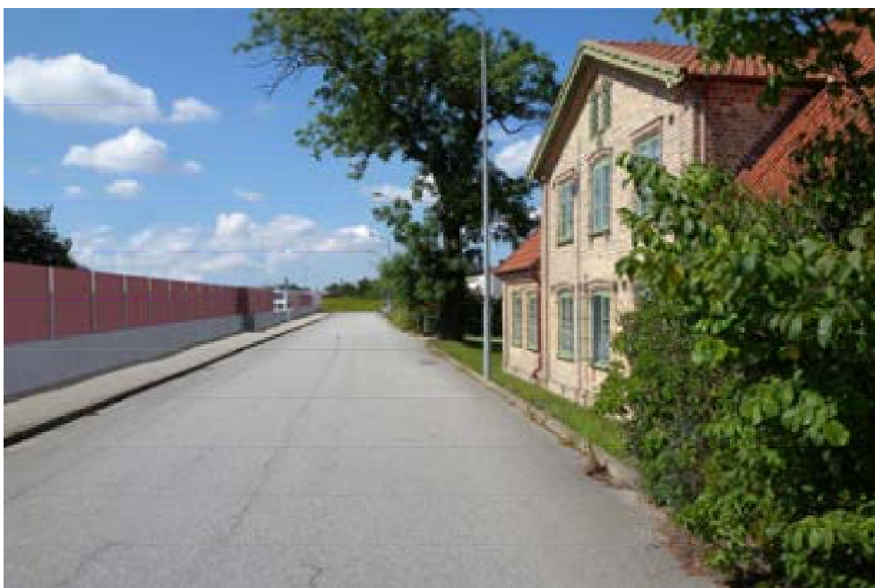
Bild 52: Möjlig utformning av bullerskydd längs Bruksvägen efter utbyggnad av järnvägen. Bullerskydden kan utformas i olika material, exempelvis glas, tegel, trä, betong eller kombinationer av olika material. På idéskissen är bullerskyddet cirka två meter högt.
